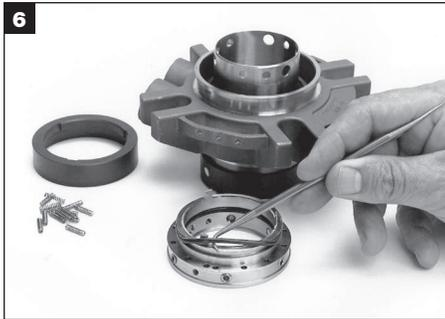
Déposez les ressorts et les joints toriques de la bague de verrouillage.
