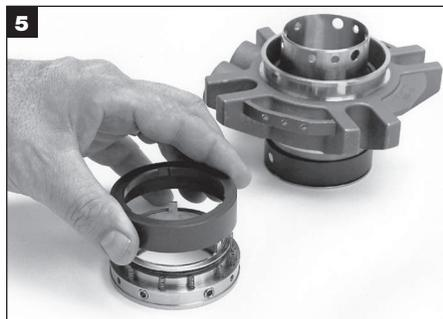
Séparez le grain tournant et la bague de verrouillage.
