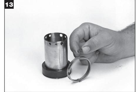
Si les deux clips d'entraînement ne sont pas encore fixés, montez les deux clips d'entraînement dans les encoches du canal d'écoulement. Remarque : il y a quatre clips pour les tailles supérieures à 60 mm et 2,50 po.
