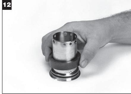
Lubrifiez le joint torique du diamètre intérieur du manchon avec la graisse silicone fournie et posez-le dans la gorge de joint torique du diamètre intérieur du manchon. Lubrifiez le joint torique tournant du manchon et posez-le dans la gorge de joint torique du diamètre extérieur du manchon. Faites glisser le grain tournant sur le manchon, en alignant les taquets d'entraînement du manchon sur les encoches du grain tournant, jusqu'à ce qu'il arrive en butée.
