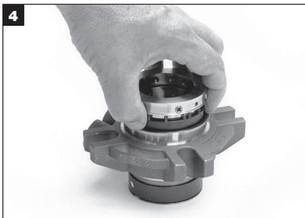
Extrayez la bague de verrouillage et l'ensemble tournant avec soin en tenant le grain tournant et la bague de verrouillage. Cela empêchera le grain tournant de tomber. Posez l'ensemble de la bague de verrouillage côté grain tournant vers le haut.
