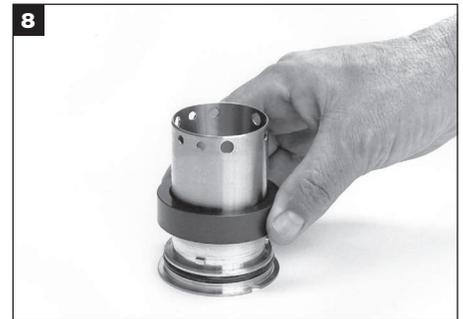
Déposez le grain tournant et les deux joints toriques du manchon.
