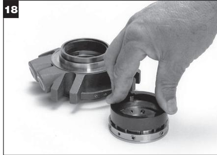
Faites glisser le grain tournant extérieur sur la bague de verrouillage jusqu'à ce qu'il soit au-dessus du joint torique, en alignant les taquets d'entraînement avec les encoches du grain tournant. Appuyez sur le grain tournant pour comprimer les ressorts afin de vous assurer que le grain tournant peut tourner librement. Essayez les faces stationnaire et du grain tournant avec un chiffon non pelucheux.
